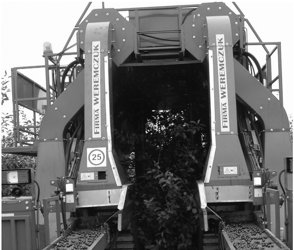
8. kép. Felix típusú önjáró meggykombájn munka közben Lengyelországban
